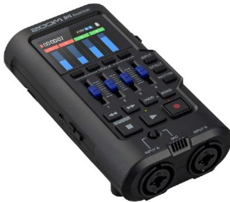
Der R4 MultiTrak ist das erste tragbare Kompaktstudio der Welt, das die 32-Bit-Float-Audiotechnologie unterstützt. Der R4 basiert auf dem beliebten Handheld-Design von Zoom und bietet Musikern und Songwritern ein verlockendes neues mobiles Gerät zum mehrspurigen Aufnehmen von Audiospuren, sei es zur Aufnahme eines Demos, oder einer Produktion mit professioneller Audioqualität und dem großen Vorteil von übersteuerungsfreien Aufnahmen.
